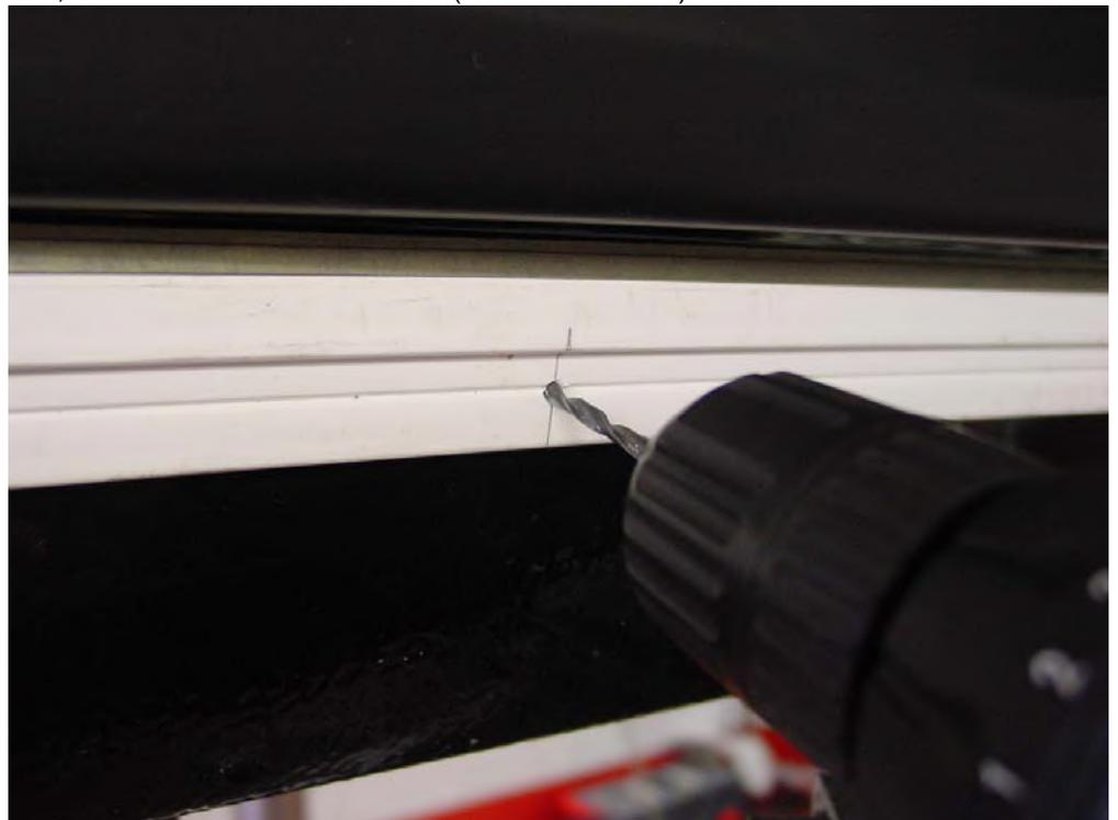
Im nächsten Arbeitsschritt müssen die Bohrpunkte auf das Fahrzeug übertragen werden. Halten Sie hierzu die Leiste an der entsprechenden Linie an. Die untere Linie ist die richtige. Der Endpunkt der Leiste muss mit der 140 mm Markierung übereinstimmen. Bohren Sie nun, von hinten beginnend, mit einem  $\varnothing$  3 mm Bohrer durch die Bohrungen in der Leiste durch das Blech. Es empfiehlt sich nach dem Bohren des ersten Loches, hier schon
