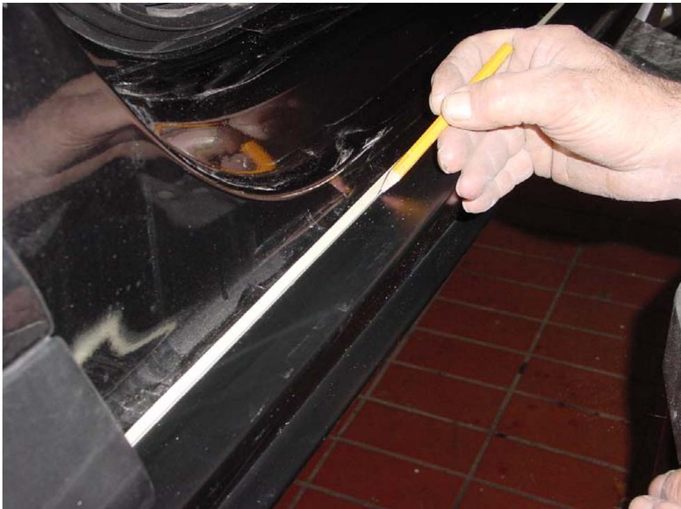
Dieses ergibt eine Positionslinie von welcher später Maße abgetragen werden, die Ihnen aber auch die Möglichkeit gibt den Schweller immer wieder an der selben Position anzulegen. Nehmen Sie den Schweller anschließen wieder ab.
